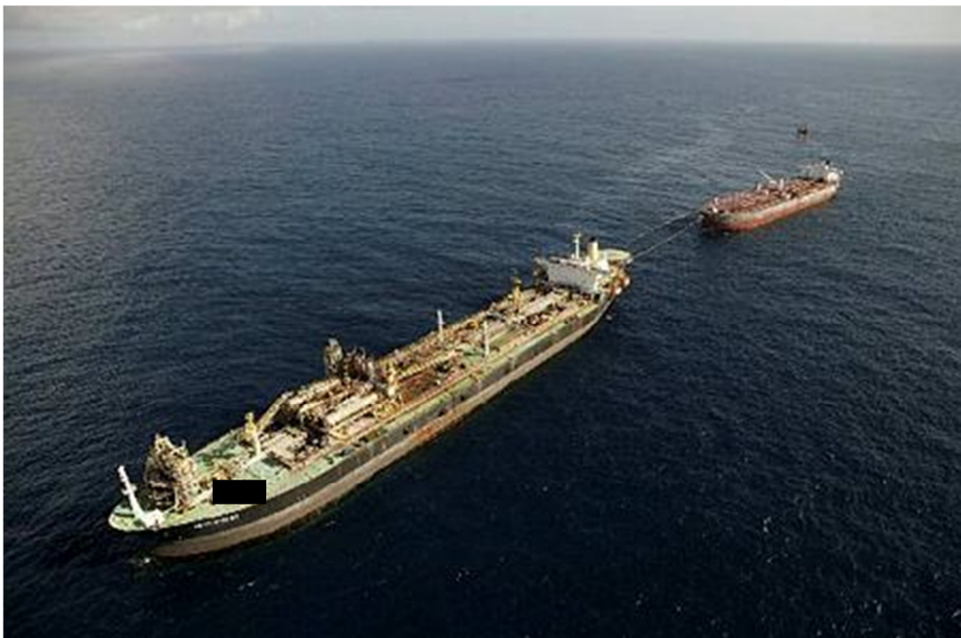
Figura 4.3 – Vista lateral do alinhando Popa da Plataforma com a Proa do Aliviador durante operação Off-loading Fonte: Arquivo pessoal
